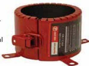
fischer Collar Corta fuego – FFC es un cilindro metálico, recubierto en color rojo y contiene un material intumescente de grafito y reactivo al calor que se expande durante un incendio.
