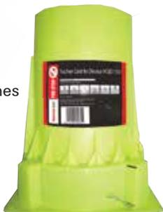
fischer FCID es un pasamuros in situ diseñado para aplicaciones en tubos no metálicos en concreto, perforaciones o pisos de losa-acero. Ensayado según AS 1530: Parte 4 y BS 476 Parte 20, el FCID brinda hasta 4 horas de resistencia al fuego.
